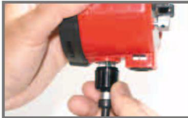
「光Dケーブル」はストロボ側もD-2000シリーズのスレーブセンサー部にネジ留めで固定するので、こちらも水中で外れることはありません。これで内蔵ストロボの光を確実に伝達できるわけです。
