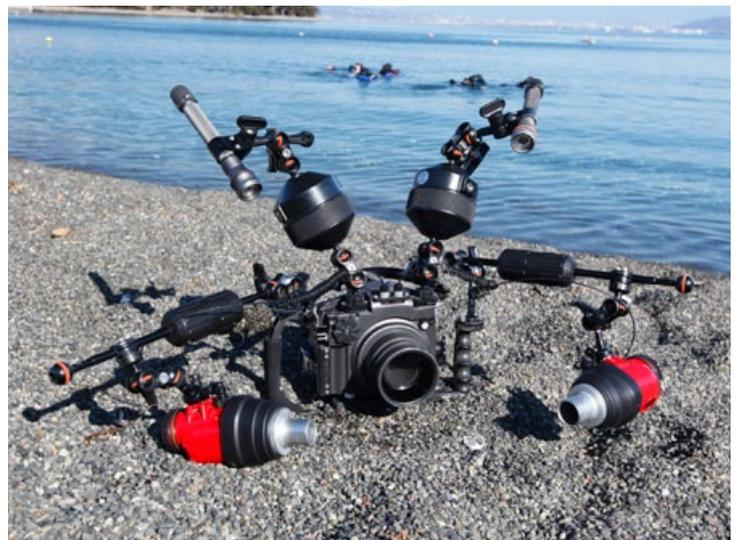
を軽減しています。また、フロートを取り付けた際のバランスは前後に偏っても使いづらいため、ハウジングが自然な水平に保たれるよう、フロートの位置など全体の構成を仕上げるのが理想的です。
