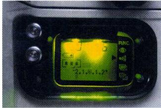
シャッター半押しだけでなく、カメラに操作を加えた際、自動的に点灯して、その後消灯する液晶パネル照明LED。情報を見たい時はいつでも、液晶パネルが明るく照らし出されているのです。約8秒間の点灯後、自動的にOFFへ戻ります。点灯させる為にボタンを押すという、煩わしい動作は必要ありません。光源のLEDには、高輝度、低消費電力タイプを採用しています。
