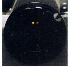
光を知らせる緑色LED / ブザーを備え、ファインダーから目を離す事無く、適正露出の確認が行えます<sup>※19</sup>。X1-LZには、ストロボレディを知らせる赤色LEDも装備<sup>※20</sup>。ストロボのチャージ状態さえ、ファインダー内から確認可能なのです。
