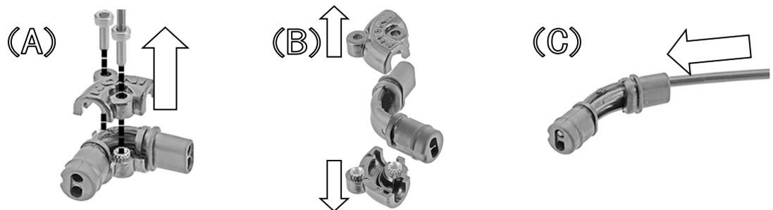
ケーブル断端をしっかりと挿し込んだ後、分解した時とは逆の手順で、L型ゴムブッシュを組み立てます。「L型ゴムブッシュ本体②」と、「L型ゴムブッシュ蓋④」、「L型ゴムブッシュ蓋(ネジ)⑤」の凹凸をしっかりと合わせた後(D)、「M2 キャップネジ③」を付属の「M2 六角レンチ」で締め付けて下さい(E)。
