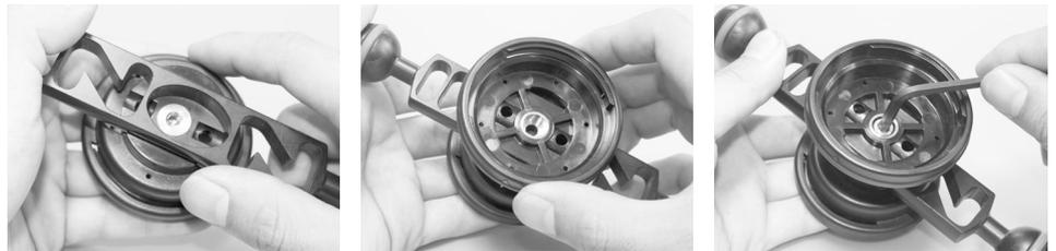
**レンズの取付け方法** : M67/ピッチ 0.75 のフィルターネジを装備した防水フロッカー、或いは、イン M67 マウントベースへの取付け法と同じです。詳細は、各レンズ 1枚 付属の使用説明書をご確認下さい。また、「塩噛み」や「電蝕」による本製品とレンズとの固着を防ぐ為、**本製品の取付けネジ部に、ワッシャー/フロッカー付属のワッシャーを少量塗って下さい。**
