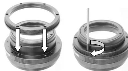
M2x4ネジは右図のように、まず①～⑥の順番で対角線状に軽く仮付けします。もう一度①～⑥の順番で対角線状に締め付けます。最後に、時計回りに締め付け固定します。一部だけが締め付けられた状態にならないよう注意しながら均等に締め付けて下さい。不均等に締め付けたり、締め付け過ぎたりすると、レンズ本体が破損する可能性があります。
