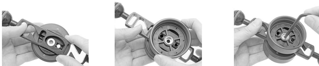
レンズの取り付け方法 : M52/ピッチ0.75のフィルターネジを装備した防水型カメラへの取り付け法と同じです。詳細は、各レンズ 付属の使用説明書をご確認下さい。また、「塩蝕み」や「電蝕」による本製品とレンズとの固着を防ぐ為、本製品の取り付けネジ部に、ハクソンカメラ付属のグリスを少量塗って下さい。
