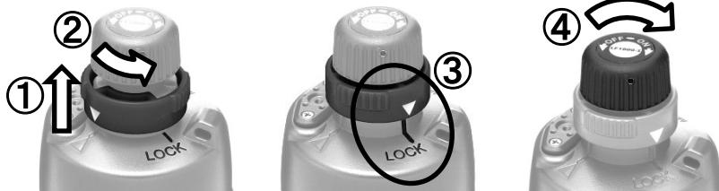
電源 OFF「ロック」状態で、“3xAA バッテリーポックス・LF”部分をしっかりと保持し、“LF1000-S ライトヘッド”を左方向(反時計方向)にゆっくりと回して取り外します。
