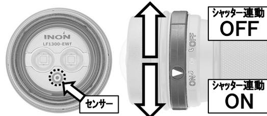
「レクターリング LF」の矢印を [ON] 位置に正しく合わせても上記動作を行わない場合は、本製品の向きを変えたり、本製品を被写体に接近させる等、「センサー」へ入射するストrobe 光量を増やして下さい。
