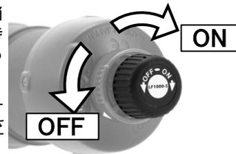
防水機能維持の為、「スイッチ」の操作、および「LF1100h-EWf ライトヘッド<sup>®</sup>」の着脱を行う際には、ゆっくりと回転させて回り、Oリングがねじれたり、破損したりしない様、ご注意ください。
