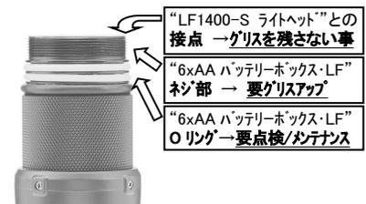
防水機能維持の為、“スイッチ”の操作、および“LF1400-S ライトヘッド”の着脱を行う際には、ゆっくりと回転させて行い、Oリングがねじれたり、破損したりしない様、ご注意ください。
