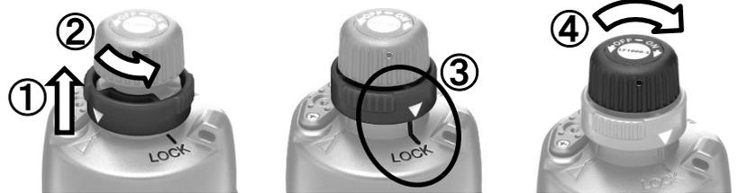
電源 OFF「ロック」状態で、“6xAA 電池ボックス・LF”部分をしっかりと保持し、“LF1400-S ライトヘッド”を左方向(反時計方向)にゆっくりと回して取り外します。
