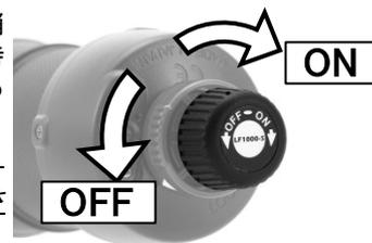
Full モード /OFF 時共に、**スイッチは軽く止まるまで回し切って下さい。**また、Low モード時には、**Full モード/OFF から切り替わった所から更に約 1/4 回転させて下さい。**中間位置では、接触が悪い場合があり、ライトが予期せず消灯/点灯したり、点滅したりといった、不安定な動作を行う可能性があります。
