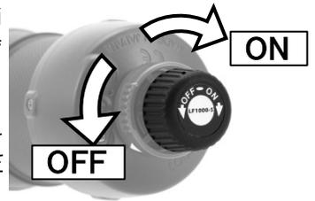
Full モード / OFF 時共に、スイッチは軽く止まるまで回し切って下さい。また、Low モード時には、Full モード / OFF から切り替わった所から更に約 1/4 回転させて下さい。中間位置では、接触が悪い場合があり、ライトが予期せず消灯/点灯したり、点滅したりといった、不安定な動作を行う可能性があります。
