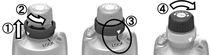
電源 OFF「ロック」状態で、“3xAA バッテリーボックス・LF” 部分をしっかりと保持し、“LF800-N ライトヘッド” を左方向 (反時計方向) にゆっくりと回して取り外します。
