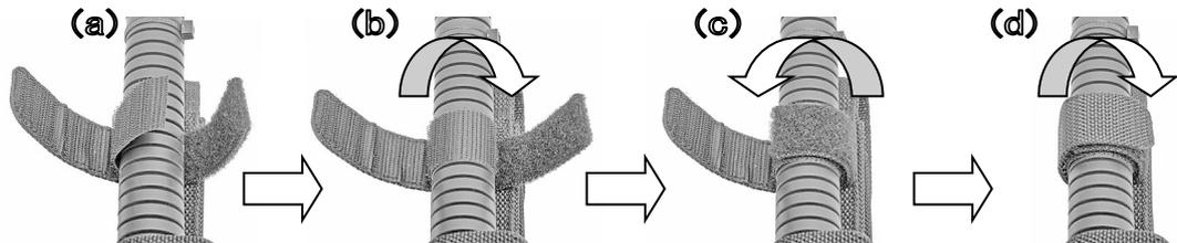
まず、「ライトケース・LF 6AA 本体」のベルクロテープを剥がした上で、取り付け対象となるホース／ベルトを中央に位置させて下さい(a)。次に、中央のベルクロテープ(フック起毛側)をしっかりとホースに巻きつけた後(b)、画像右端のベルクロテープ(ループ起毛)を折り重ねるようにして貼り付け(c)、最後に画像左端のベルクロテープ(フック起毛)を強く貼り付けて下さい(d)。
