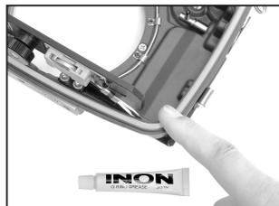
Oリングに傷がない場合でも、変形や磨耗、素材の経年変化等の原因によって、Oリング自体が劣化します。ご自身でメンテナンスできない部分と併せて、**定期的に弊社によるメンテナンスを受けることをおすすめします**。詳細は、「末永くご使用頂く為に --- オーバーホールに関して」(38 ページ) を参照してください。
