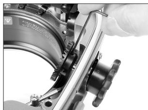
改善しない場合、クラウンギアとフォーカスギア・ズームギアの噛み合わせを調整します。ズーム / フォーカスダイヤルを押し込んだ状態で、クラウンギアとフォーカスギア・ズームギアとの間に僅かな遊びがあり、スムーズに回るまで、付属品の六角レンチ 1.5mmを用いて、クラウンギアの位置を調節してください。
