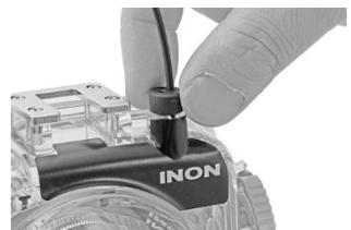
この際、カメラの内蔵フラッシュの光が確実に伝わる様、L型光Dケーブルの「光ファイバ-断端」を、「光ファイバ-用・2穴ゴムブッシュ」からわずかに(0.5mm程度)突き出させます。L型光Dケーブルは、1つの「光ファイバ-用・2穴ゴムブッシュ」に、1本のみでも2本同時でも、どちらでも固定する事が可能です。
