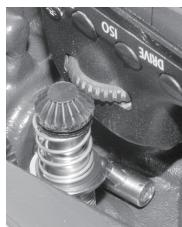
ハウジング内部のシャッターレバーがカメラに干渉していないか、ハウジング内部のゴム製ダイヤルがカメラのメイン電子ダイヤル前の突起部に当たっていないか確認し、カメラ取り付けネジを時計回りに締め、カメラを固定してください。
