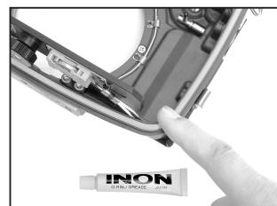
Oリングに傷がない場合でも、変形や磨耗、素材の経年変化等の原因によって、Oリング自体が劣化します。ご自身でメンテナンスできない部分と併せて、定期的に弊社によるメンテナンスを受けることをおすすめします。詳細は、「未永くご使用頂く為に --- オーバーホールに関して」(38 ページ) を参照してください。
